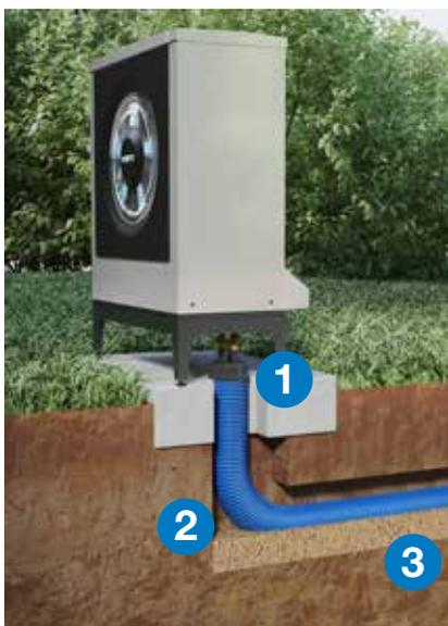
1. Pour les raccords extérieurs, l'utilisation d'embouts étanches est obligatoire pour éviter d'endommager l'isolation par la pénétration d'eau.
